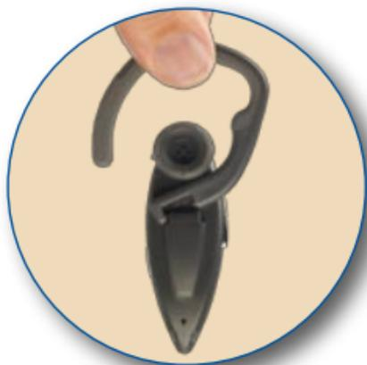
Pointez la partie arrière de l'oreillette vers le bas puis placez le bout du crochet du coude sur le côté gauche du support de fixation.
