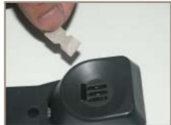
Une fois le bon emplacement défini, utilisez l'autocollant pour le maintenir en position. Attention de ne pas obstruer la sortie du son avec l'autocollant.
