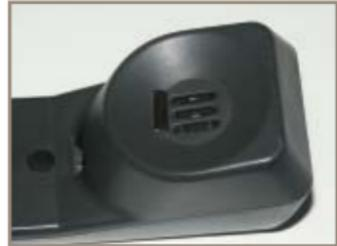
Le combiné doit être propre et sec pour déterminer le bon emplacement de l'aimant, tenez-le quelques centimètres au-dessus de la sortie écouteur et lâchez-le. Il se placera automatiquement en position optimale sur le combiné.
